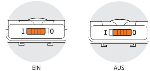
Schieben Sie die An-/Aus-Taste zum Einschalten des FreeWire-Geräts auf I. Schieben Sie die An-/Aus-Taste zum Ausschalten auf O.
