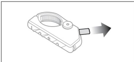
Entfernen Sie das Klebeband vom Akkufach, um mit der Nutzung des RC4 zu beginnen.
